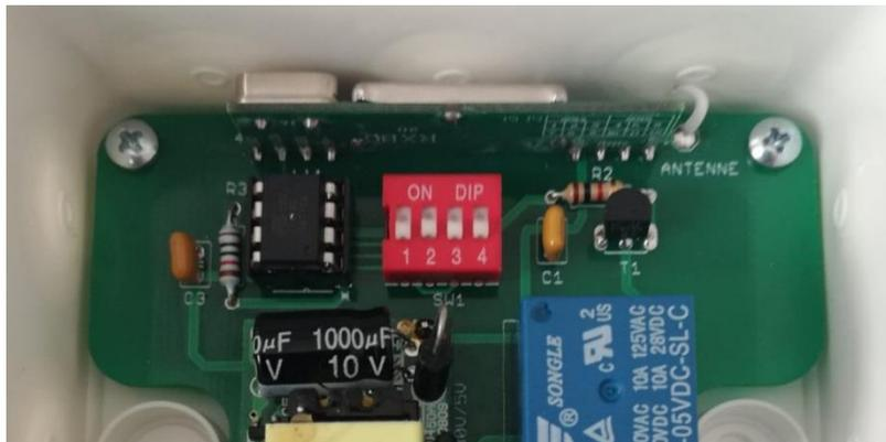
Da es möglich ist, in einem Haus mehrere Steuergeräte zu installieren, die unabhängig voneinander schalten sollen, muss jede Anlage auf einem eigenen Kanal senden (ähnlich wie bei WLAN-Netzen). Auch in Mehrfamilienhäusern kann es vorkommen, dass jede Wohnung eine eigene Anlage besitzt. Damit nun das Steuergerät nur die Funkempfänger schaltet, die auch zur Anlage gehören, und nicht alle, können Sie zwischen 4 Kanälen wählen, die durch die oben abgebildeten Schalter eingestellt werden.
